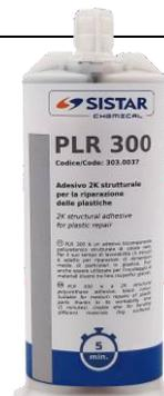
PLR 300 è un adesivo bicomponente poliuretano strutturale di colore nero. Per il suo tempo di lavorabilità (5 minuti) è adatto per le riparazioni e ricostruzioni di particolari in plastica di dimensioni medie. Può anche essere utilizzato per l'incollaggio di materiali diversi tra loro (medie-grandi superfici).
