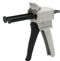
La miscela deve essere applicata direttamente dal miscelatore sulla superficie pre-trattata ed asciutta. Lo strato ottimale di adesivo che garantisce alla giunzione la massima resistenza ha uno spessore minimo di 0,5 mm. I componenti vanno assemblati prima che l'adesivo inizi ad indurire e serrati con pressione di contatto uniforme su tutta l'area di incollaggio.
