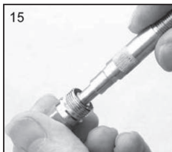
15. Coloque la junta en el alojamiento (10).
