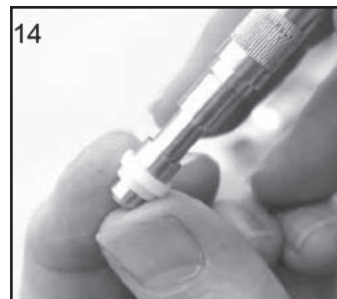
14. Instale una junta nueva en la herramienta de mantenimiento.
