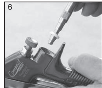
6. Retire el asiento de la válvula.
