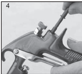
4. Retire la válvula (11).
