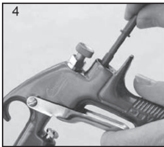
4. Retire la válvula (11).
