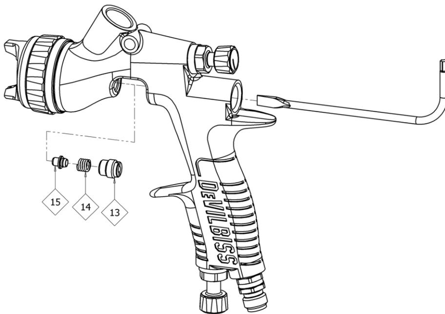
MONTAGGIO GUARNIZIONI VALVOLA DELL'ARIA
