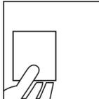
Dopo aver agitato la bomboletta, provare a spruzzare e verificare la compatibilità con la superficie e il colore
