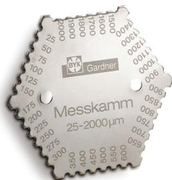
Spessimetro esagonale riutilizzabile in acciaio inox per controllare lo spessore del film di vernice appena applicata e ancora bagnata. Sei lati di misurazione da 25 a 2000  $\mu\text{m}$ . A norma ASTM D4414, D713.
